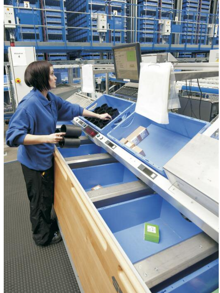
Die Pickstation von SSI Schäfer ermöglicht eine hoch effiziente ‚Pick-to-Tote-‘Kommissionierung
